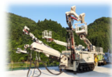
吹付け機 Tunnel RemOS -Spray 道路トンネルにて2024.10より試行開始予定
