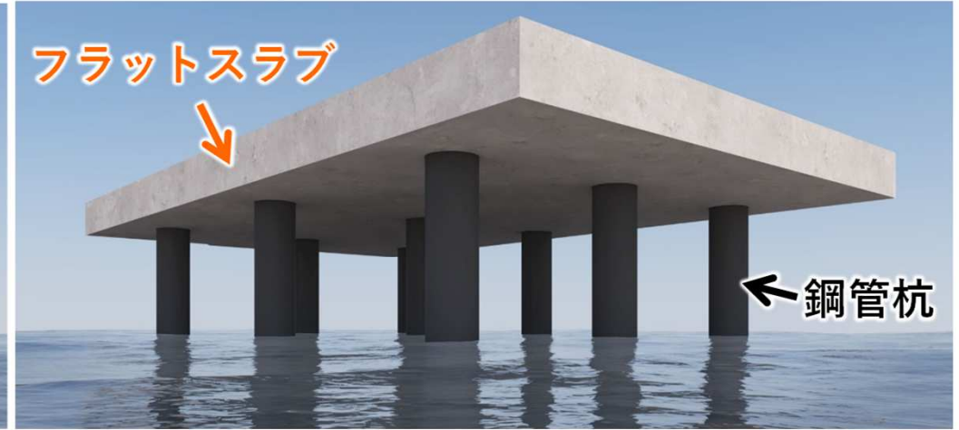
本栈橋：フラットスラブ構造
