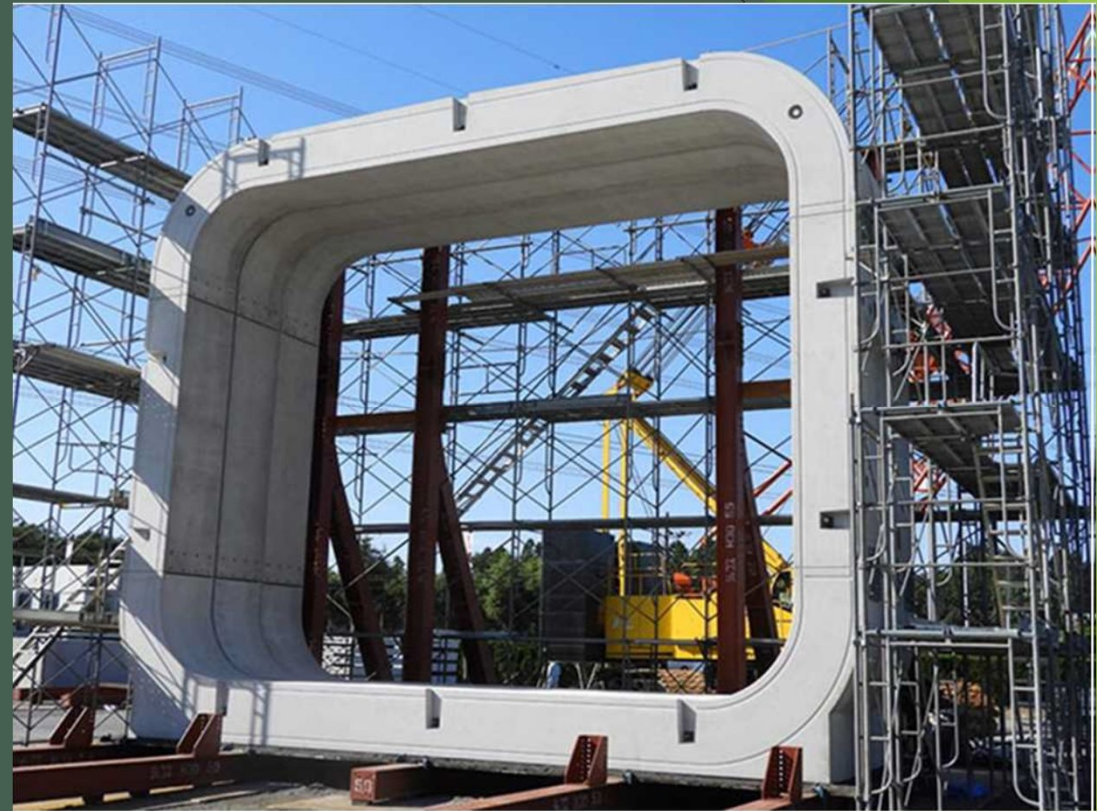
工場内組立試験状況
