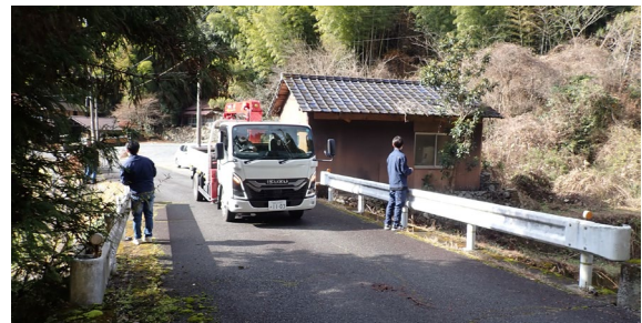
図-4 車両走行試験の様子（A 市：長谷橋）
