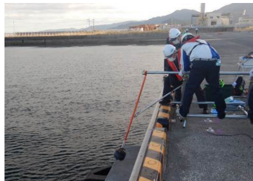
写真-4 打撃振動試験状況
