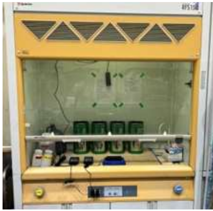
図-2(b) 室内でのCO 2 固定実験状況 5)
