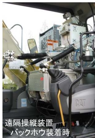
遠隔操縦装置 バックホウ装着時
