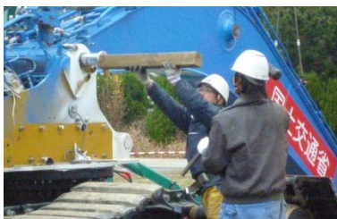
上部旋回フレームと ブームのピン設置
