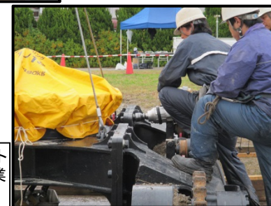
上部旋回フレームと下部旋回フレームの分解作業 (油圧ホース取り外し) (接合ボルト取り外し)
