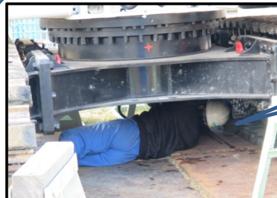
上部旋回フレームと下部旋回フレームの分解作業 (油圧ホース取り外し) (接合ボルト取り外し)
