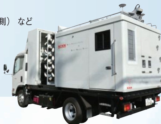
トンネル点検車両(MIMM®)
