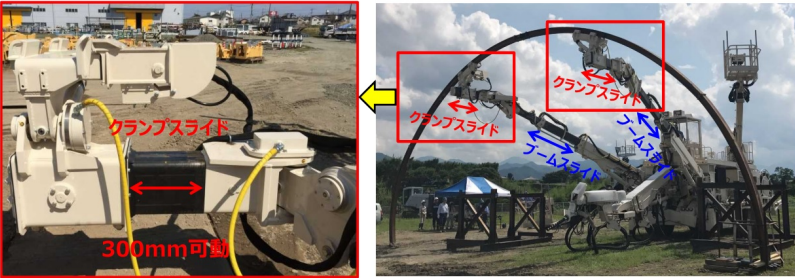
クランプ部 拡大写真 マシン本体 全景 「微調整機能付きエレクター」詳細
