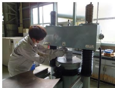
強度の異なるコンクリートから作成した再生骨材を用いたコンクリートの中性化特性に及ぼす影響の研究に取り組んでいます。
