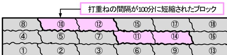
図 コールドジョイントの発生を抑制する方法の例
