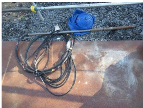
図-5 バイブレータ例
