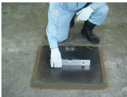
①水密性平板は安定した場所に設置し、水準器により水平を確認する。
