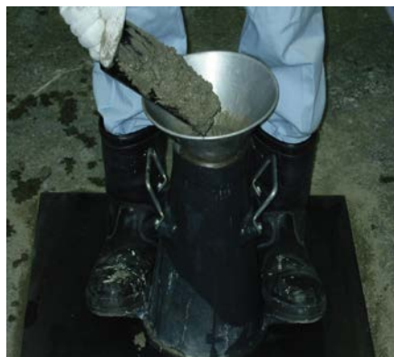
③試料は、ほぼ等しい量の3層に分けて詰める(1層目:高さ約8cmまで、2層目:高さ約18cmまで)。詰め方は、一方向から入れない。
