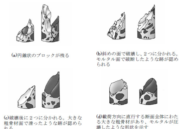
図 12-6 コアの破壊形状パターン図
