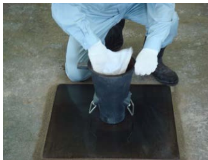
②水密性平板およびスランプコーンを湿布で拭き、平板の中央部にスランプコーンをセットする。
