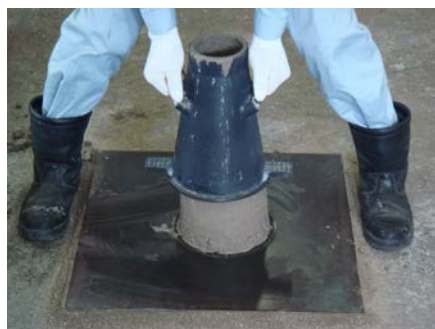
⑤突き棒により突き終わった後、上面をコテで均し、スランプコーンを鉛直に30cmを2～3秒で引き上げる。
