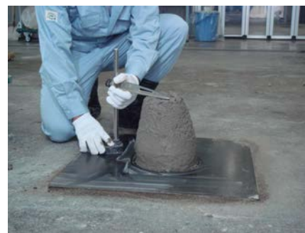
⑥コーンを引き上げた後、直ちにコンクリートの中央部を検尺により測定し、0.5cm単位で読み取る。
