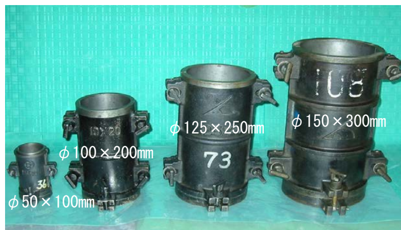
写真 6-6 型枠の種類(一例)
