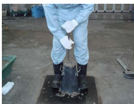
④突き棒による突き方は外周からうず状に中心に向かって、各層25回突き、突き深さは前層に届く程度とする。
