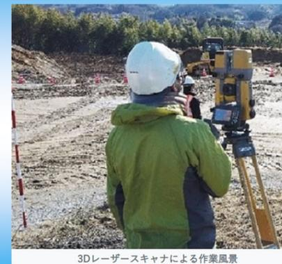
3Dレーザースキャナによる作業風景
