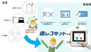
本技術は、作業員の就業状況等を管理するCCUSを運用するユニットシステムで、従来は、現場管理者が作業員の記入する出退勤時刻の台帳整理と目視の本人確認で就業状況等を管理していた。本技術により、記入・集計・確認作業が低減され、施工性、経済性の向上が図れる。技術は、土工（ICT）に関する技術である。ICT施工非対応バックホウをメーカーを問わず安価に3次元マシンガイダンスシヨベル化するキットおよびシステムで、従来は、ICT施工対応型油圧シヨベルで対応していた。本技術の活用により、経済性が向上する。
