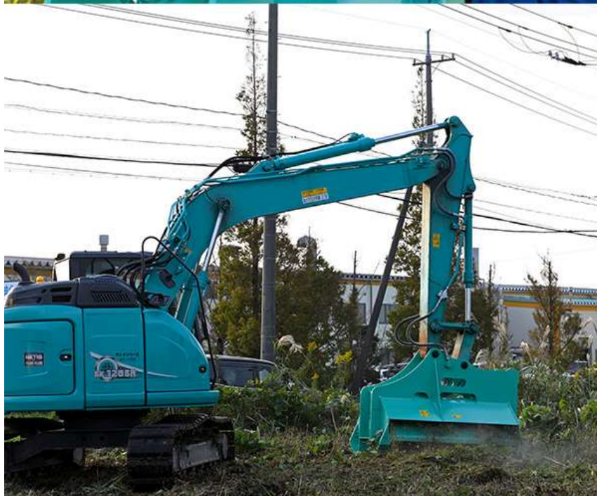
油圧ショベルへ装着したクサカルゴンでの施工方法（上：装着確認、下：除草作業中）
