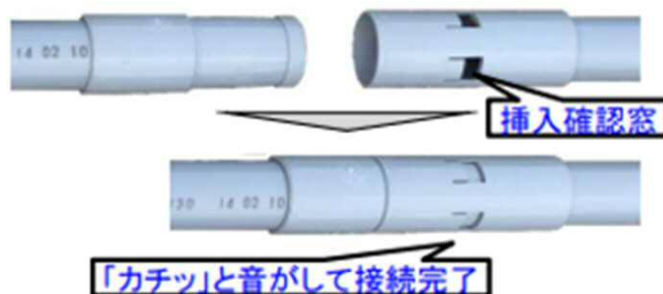
ボディ管内さや管接続作業
