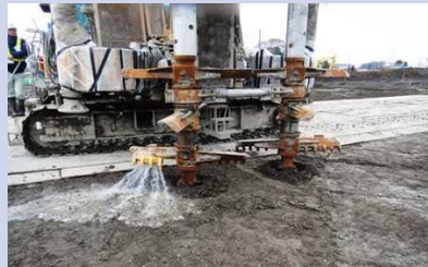
新型攪拌翼とエジェクター吐出口
