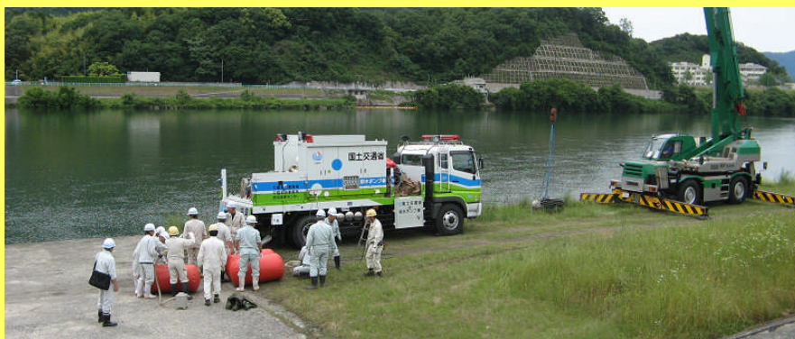
排水ポンプ車（訓練状況）
