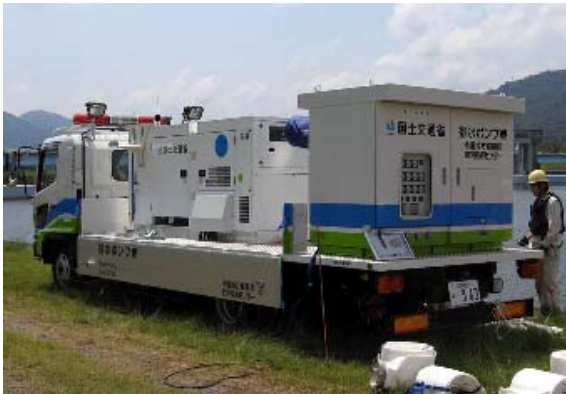
排水ポンプ車
