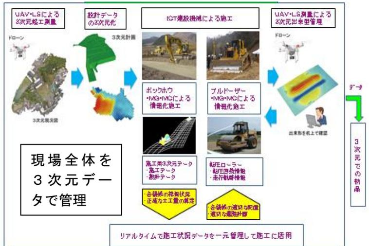
図-2 ICT土工と施工プロセス
