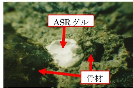
写真-10 ASRゲル (実体顕微鏡写真)
