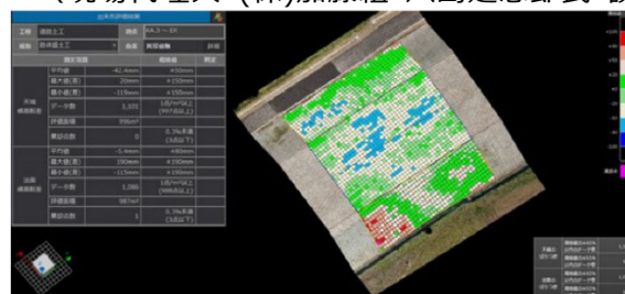
図-16 3次元データによる出来形管理状況
