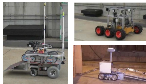
写真-16 ガス濃度・画像データを取得するロボットの例
