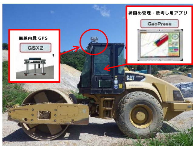
写真-13 振動ローラー
