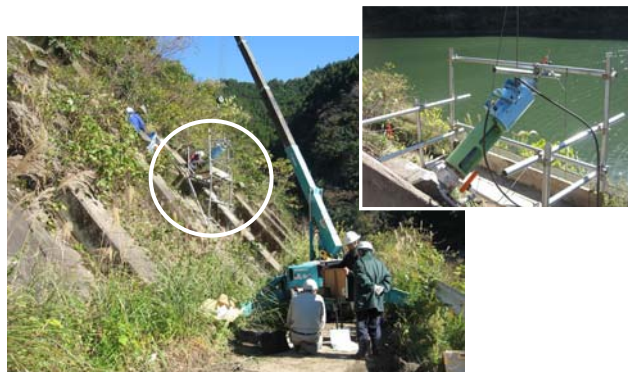
写真-4 リフトオフ試験によるアンカー残存引張り力測定
