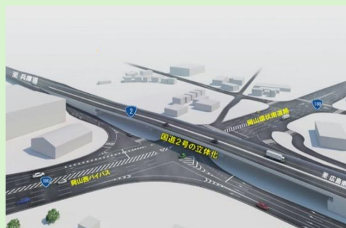
立体交差の例（大樋橋西交差点）
