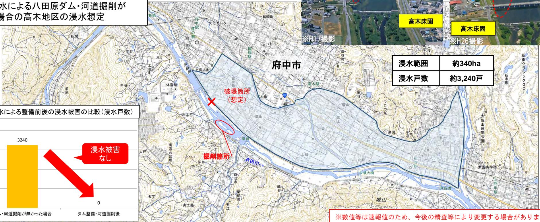
今回の洪水による整備前後の浸水被害の比較(浸水戸数)
