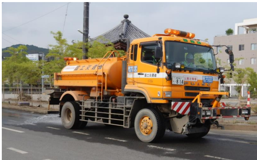
散水作業（倉敷市真備町）
