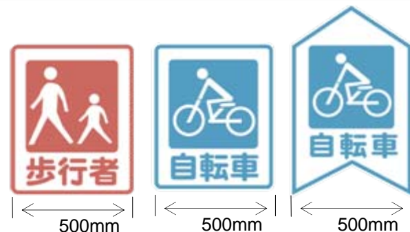
歩行者・自転車の通行空間を示す路面標示
