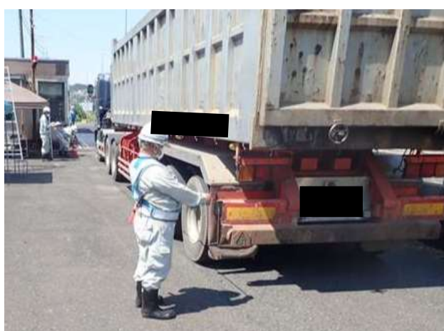
車両軸長計測状況（R2. 8）
