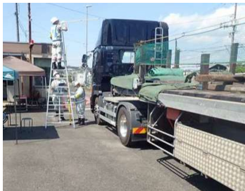
車両高計測状況（R2.8）
