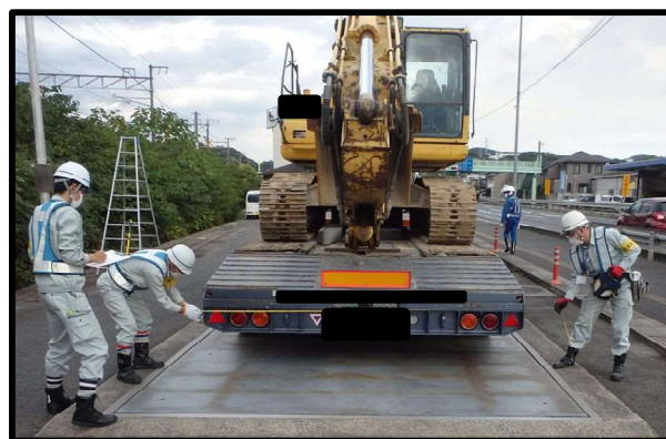
車両幅計測状況（R3.10.19）
