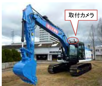
重機へのカメラ取付例
