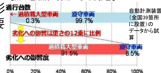
【図 道路橋の劣化に与える影響】
