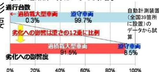
【図 道路橋の劣化に与える影響】
