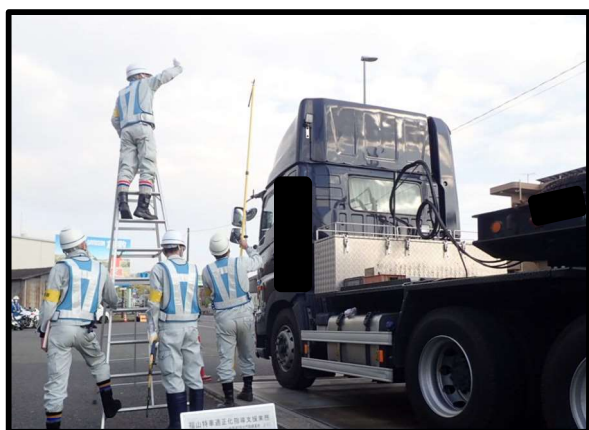
車両高計測状況（R3.11.17）
