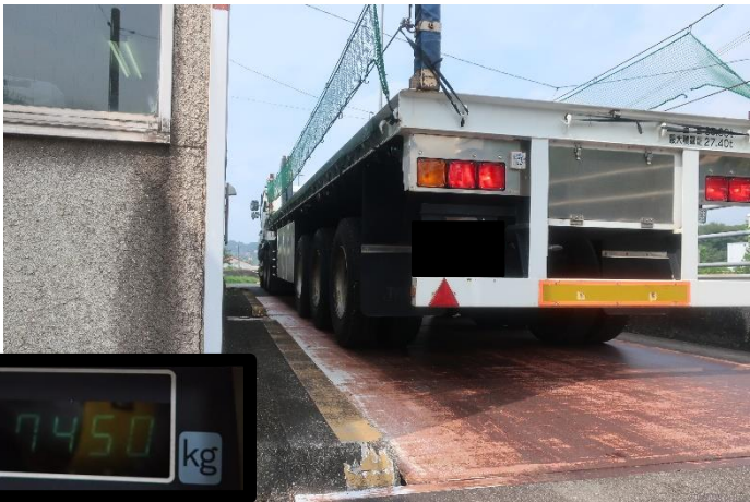
車両重量計測
