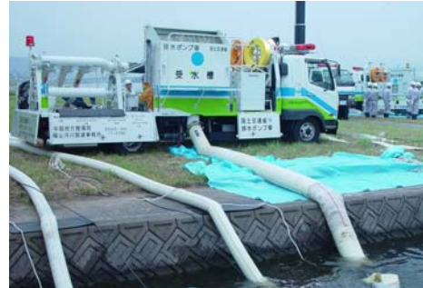
写真 5-2-30 排水ポンプ車
