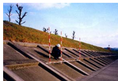
写真 5-2-5 洪水痕跡調査
