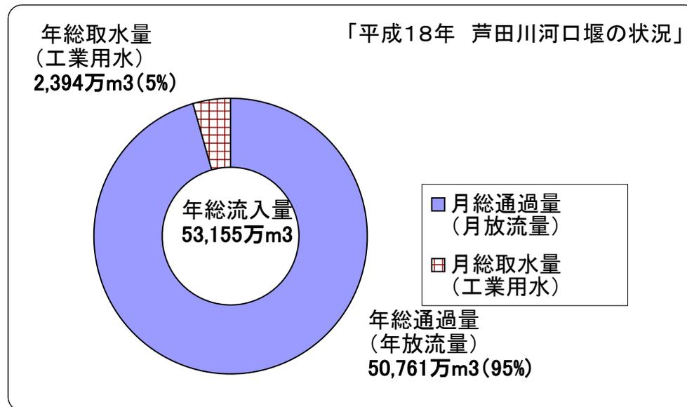
平成18年の芦田川河口堰の年間総流入量は53,155万m3で、その内、工業用水として2,394万m3を取水し、残りの50,761万m3を河口に流しています。
