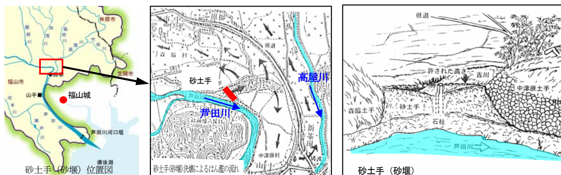
図 1-2-1 砂土手（砂堰）（福山市御幸町中津原）
