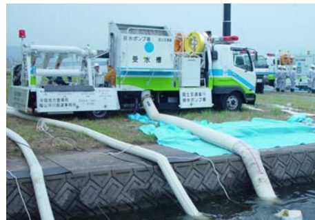
写真 5-2-30 排水ポンプ車
