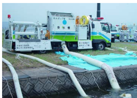
写真 5-2-30 排水ポンプ車
