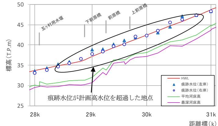
図 2-1-2 平成 30 年 7 月豪雨時の痕跡水位縦断図 (目崎地点 (府中上流))
