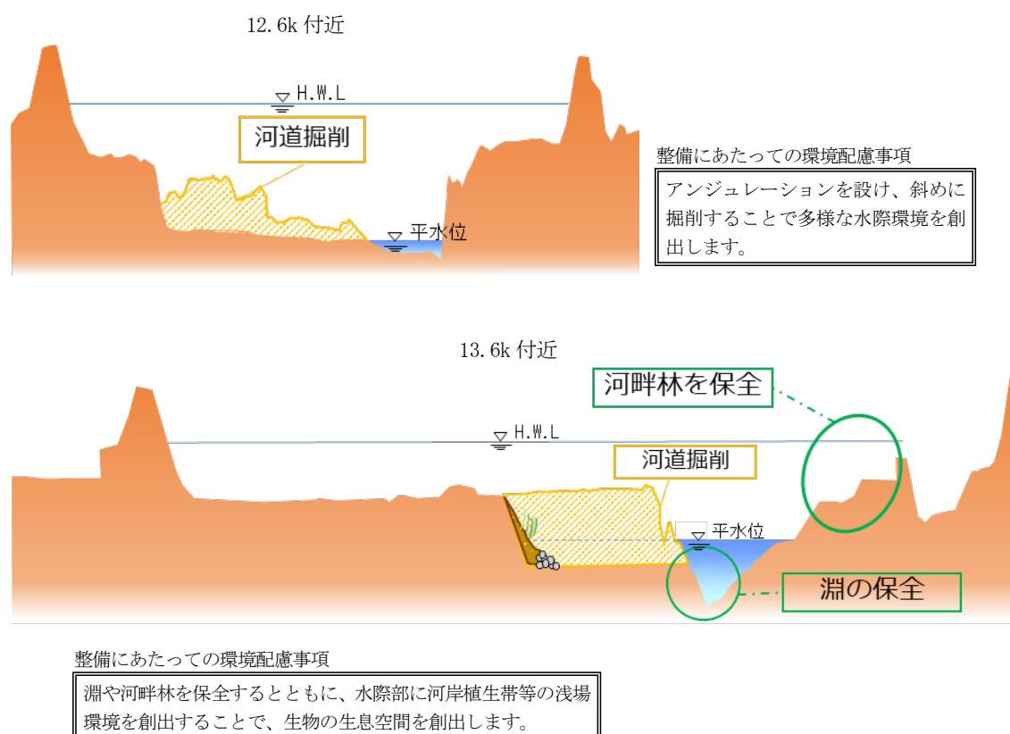
図 5-1-4 河道掘削のイメージ図
