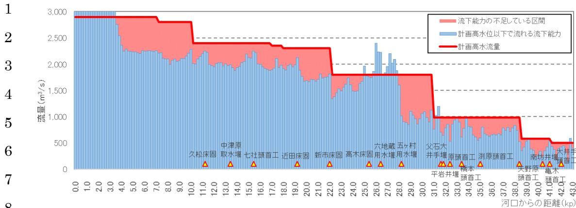
図 2-1-1(1) 流下能力図 (芦田川)
