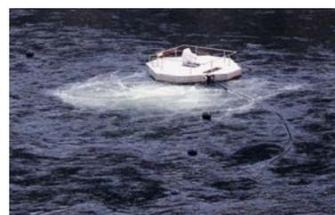
写真 5-1-12 躍層低下循環装置
