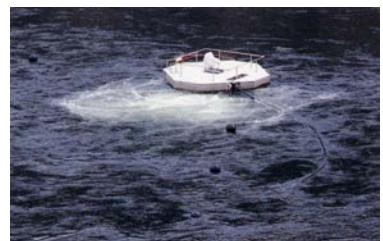
写真 5-1-12 跳躍低下循環装置
