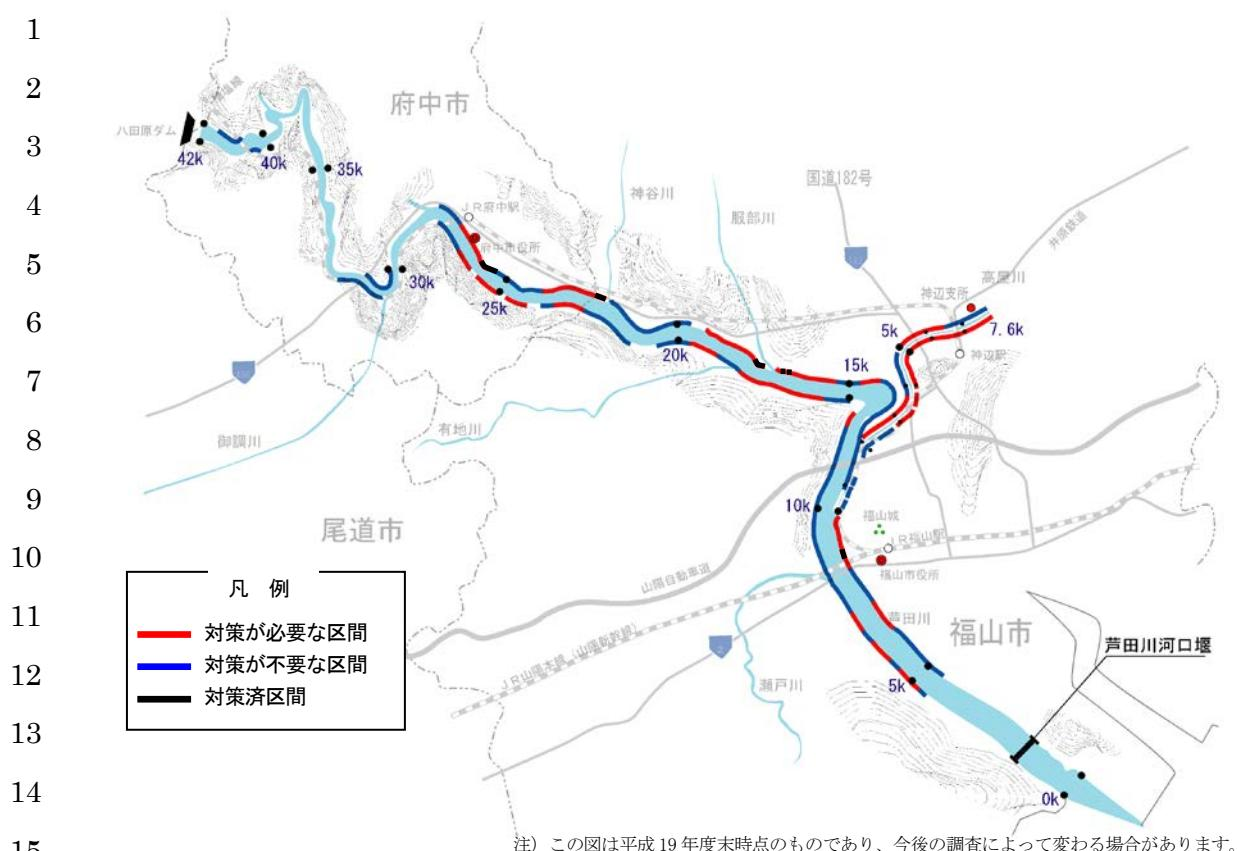
図 2-1-4 堤防の浸透に対する安全性照査の実施状況
