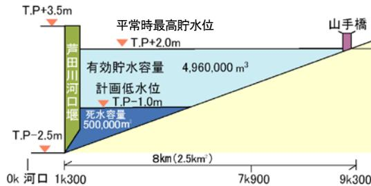
図 1-2-4 芦田川河口堰貯水容量図
