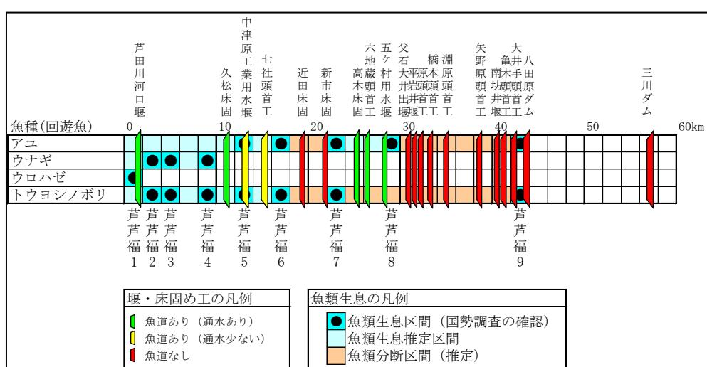
32 図 5-1-15 魚類の生息区間と堰・床固工の状況
