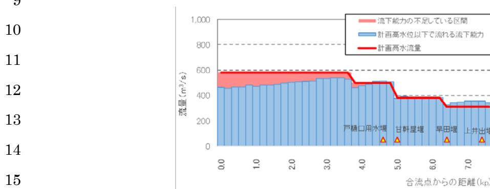
図 2-1-1(2) 流下能力図 (高屋川)
