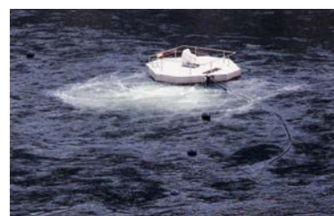
写真 5-1-12 躍層低下循環装置
