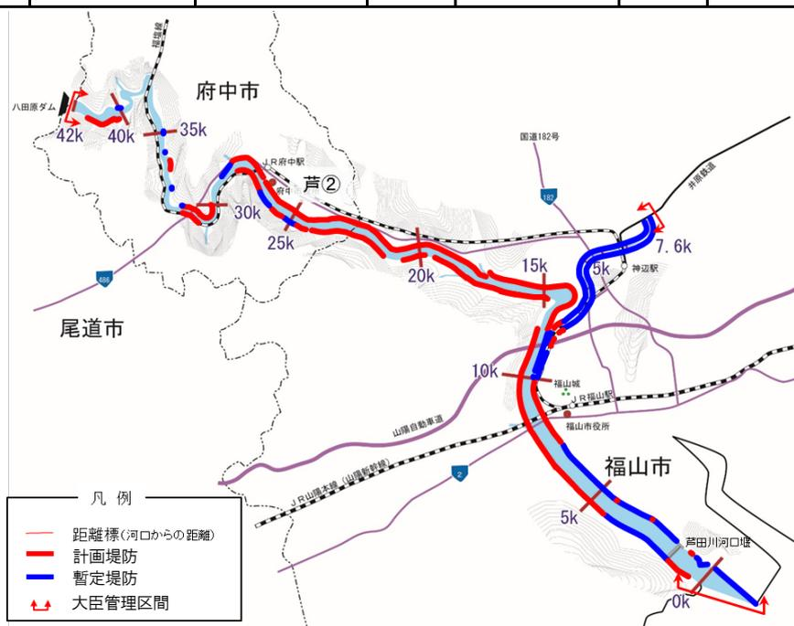
図 2-1-3 堤防整備状況平面図
