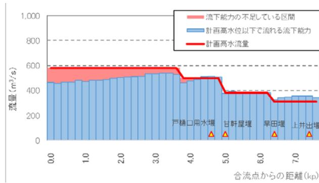
図 2-1-1 (2) 流下能力図 (高屋川)
