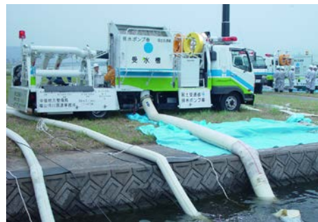
14 写真 5-2-30 排水ポンプ車
