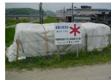
写真 5-2-34 緊急用資機材(土のう)の備蓄状況
