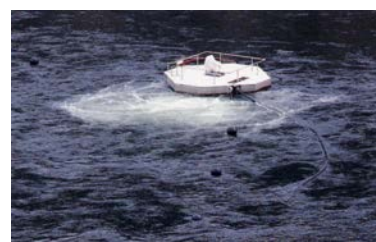
写真 5-1-12 躍層低下循環装置
