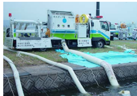
写真 5-2-30 排水ポンプ車
