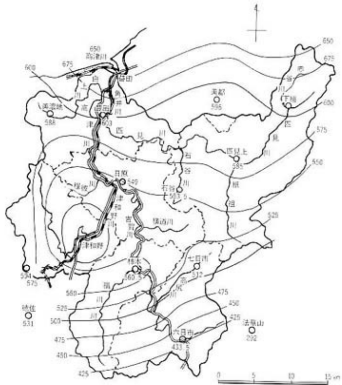
図4-19 昭和47年7月豪雨における高津川流域の総雨量分布図 (資料：建設省中国地方建設局「昭和47年7月豪雨災害誌」による)
