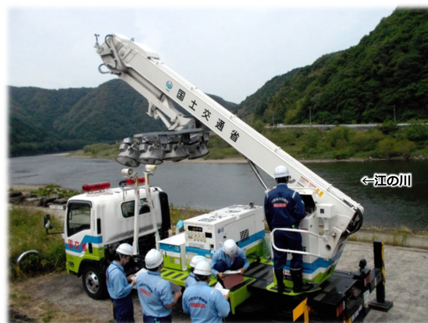
照明車の操作訓練の様子 (川本管内)
