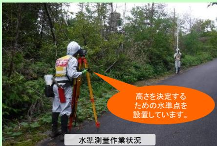
高さを決定するための水準点を設置しています。
