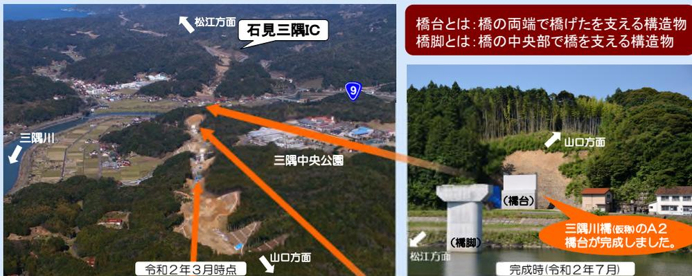
橋台とは：橋の両端で橋げたを支える構造物
